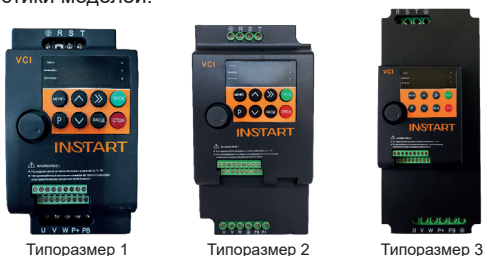
Рис.2.2 Внешний вид моделей ПЧ серии VCI
